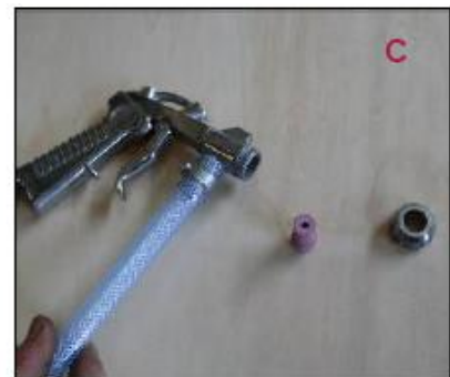
Фигура 11 – Демонтаж на дюзата на пистолета за пясъкоструене
